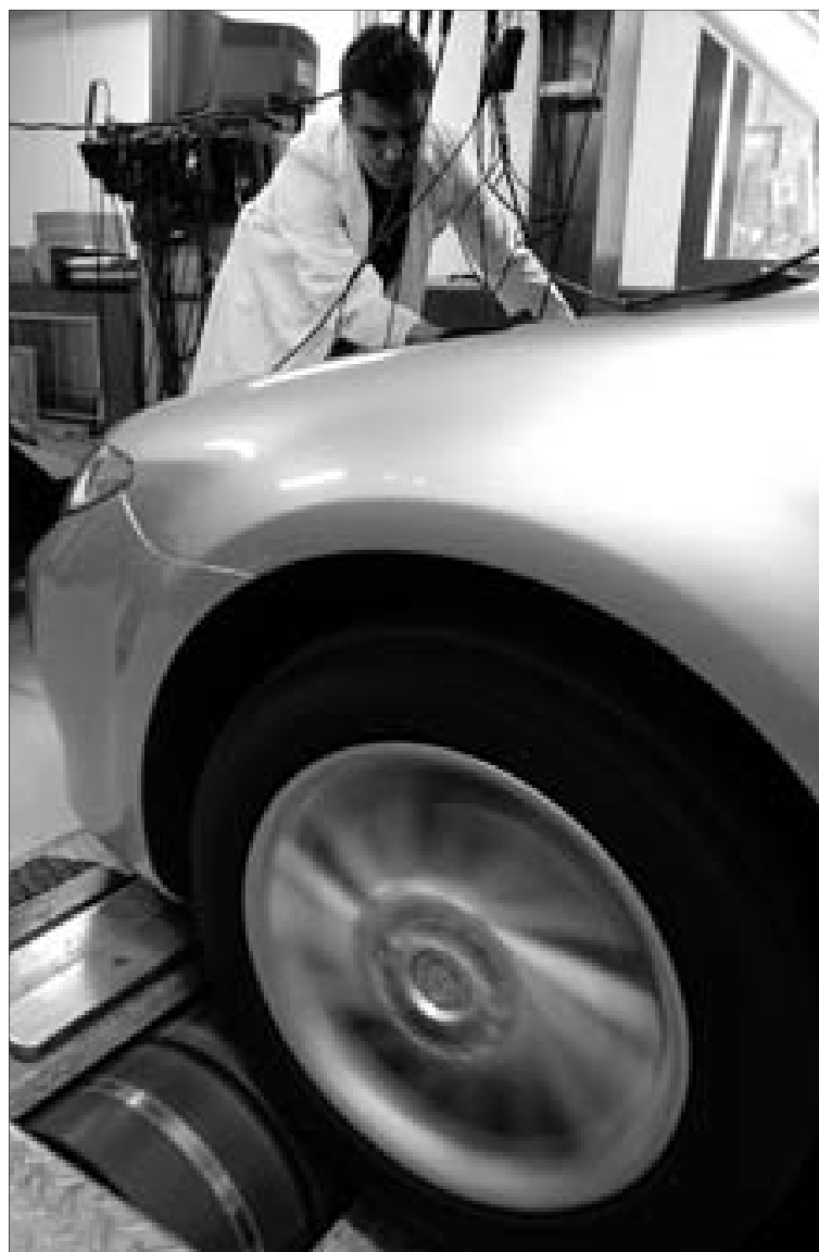
Un operario comprueba los frenos de un vehículo en una ITV en Getafe (Madrid) . / C. M.
