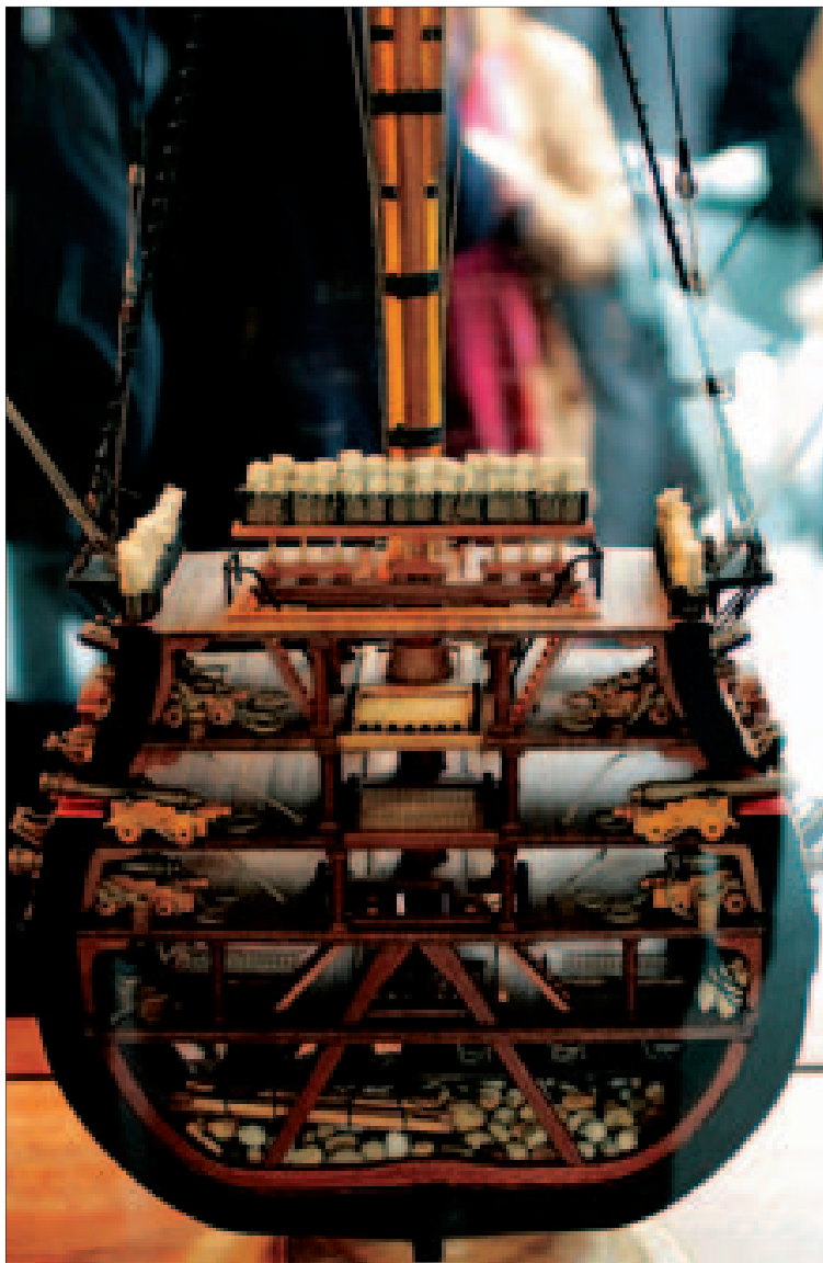
Sección de un navío de línea de los siglos XVIII y principios del XIX.
