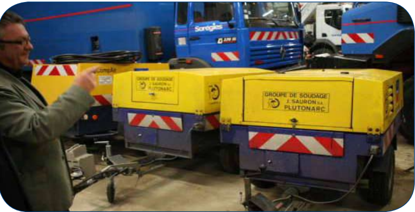
Equipements propres à Sorégies (groupes électrogènes, camions, fourgonnettes pour réaliser les travaux de gaz et d’électricité.)
