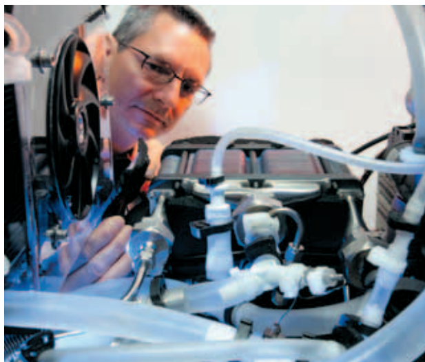
> Groupe électrogène à pile à combustible, mobile, EPICEA.
