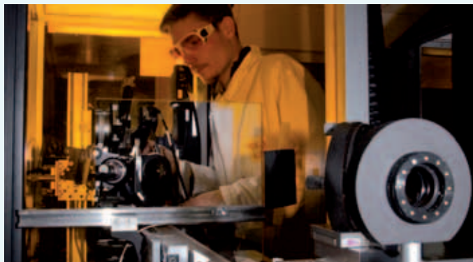
> Expérience d'endommagement pour améliorer la tenue au flux laser des optiques.
