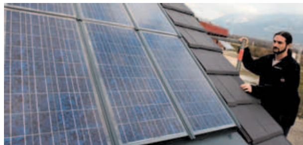
> Évaluation de capteurs solaires sur le banc d'ensoleillement.
