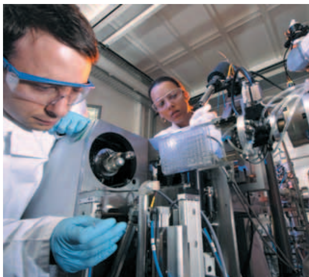
> Réglage du cryojet pour l'analyse d'échantillons contenus dans une plaque de cristallisation.
