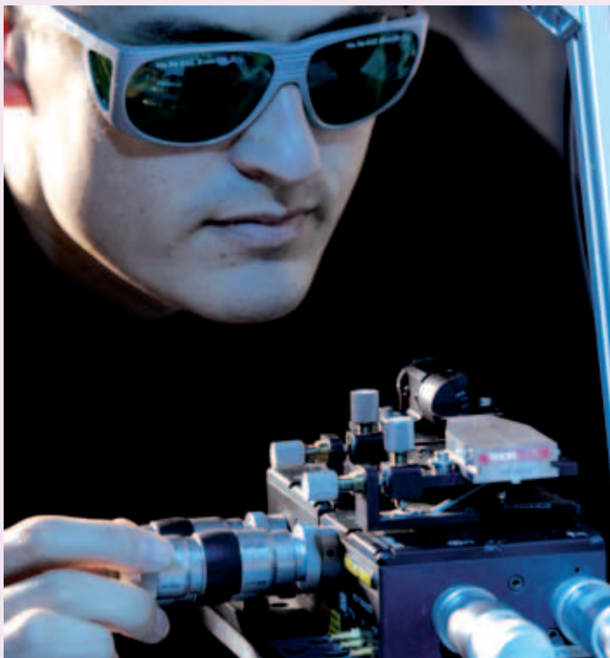
> Alignement d'une fibre optique sur un circuit intégré en technologie photonique silicium.
